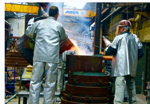
In stilte en opperste concentratie wordt door de klokkengieters het vloeibaar klokkenbrons in de vorm gegoten
